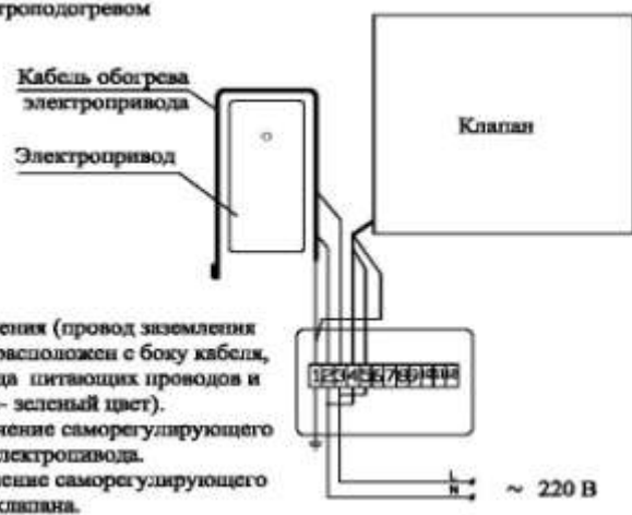
Схема электрическая принципиальная АВК-С с электроподогревом
